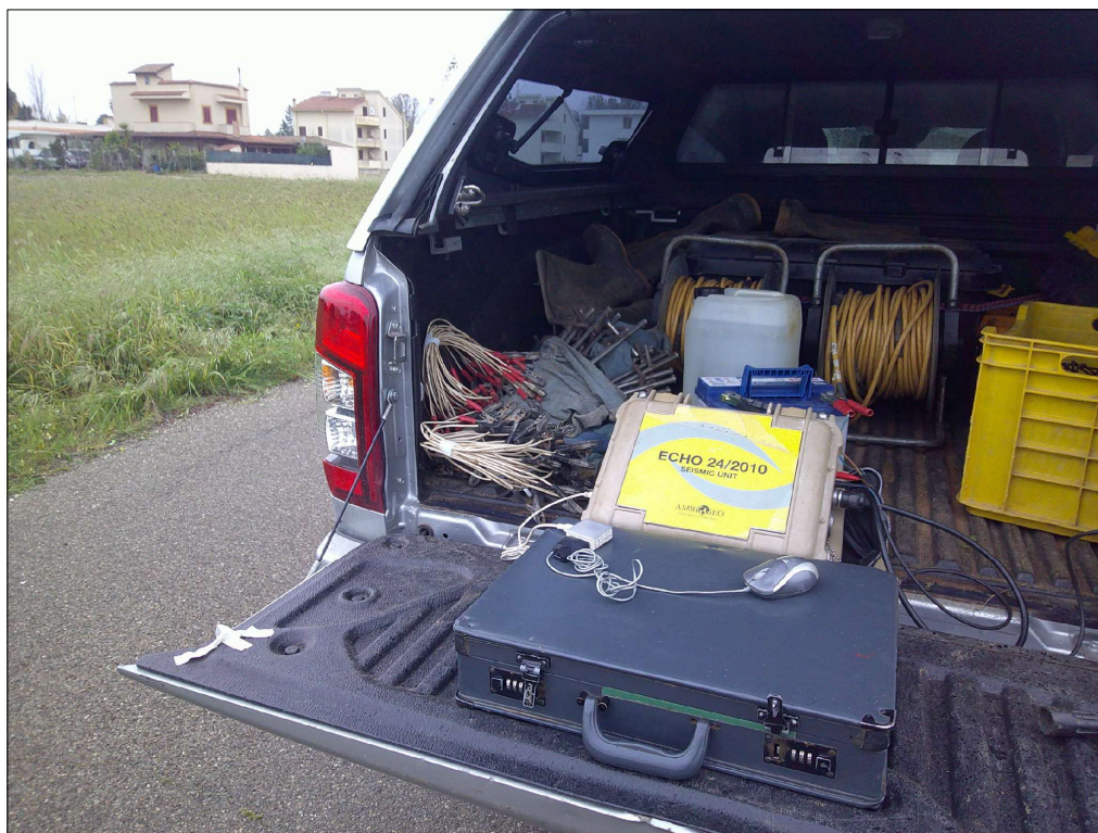
Foto 6: Particolare della stazione di acquisizione dei dati sismici [Profilo MASW.1]
