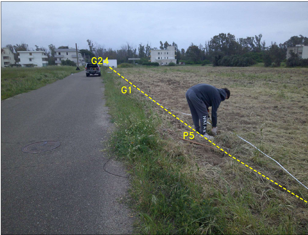
Foto 4: Postazione ed allineamento del Profilo Sismico MASW.1 – esecuzione di una battuta in onde di Love nel punto di scoppio P5 –
