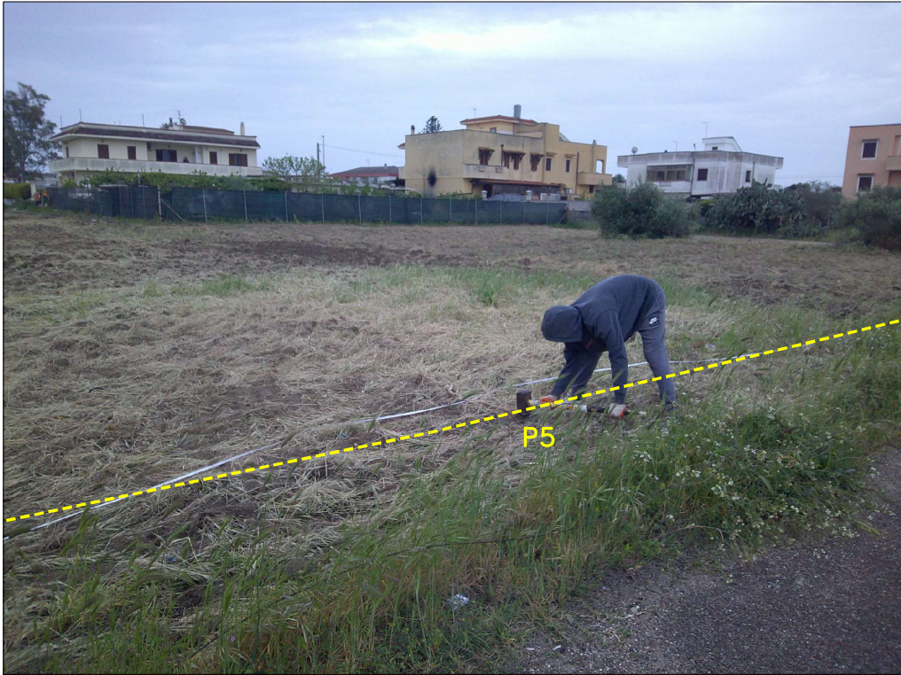
Foto 3: Postazione ed allineamento del Profilo Sismico MASW.1 – esecuzione di una battuta in onde di Rayleigh nel punto di scoppio P5 –
