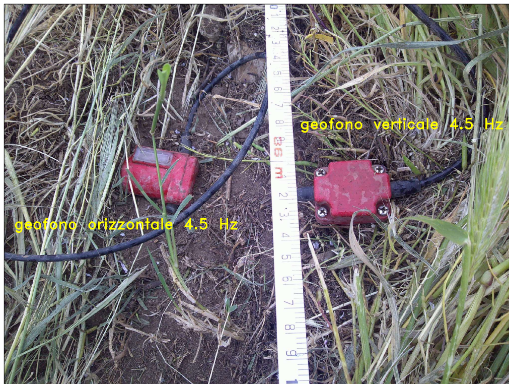
Foto 5: Particolare dei geofoni utilizzati per l'acquisizione delle onde di Rayleigh (componente verticale) e delle onde di Love (geofono orizzontale) [Profilo MASW.1]
