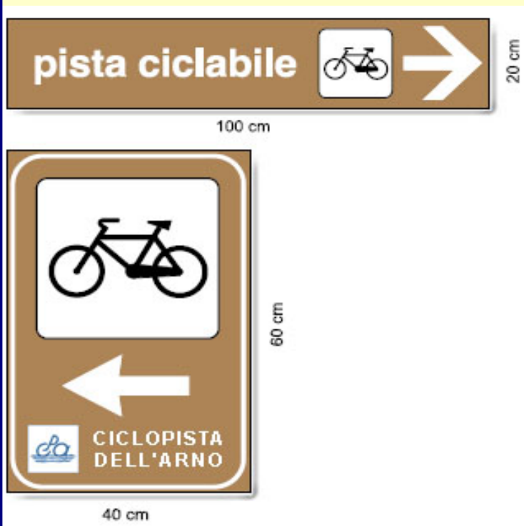
FIGURA 20 - Segnali di indicazione per destinazioni extraurbane da apporre su viabilità ordinaria per raggiungere una ciclopista generica o specifica
