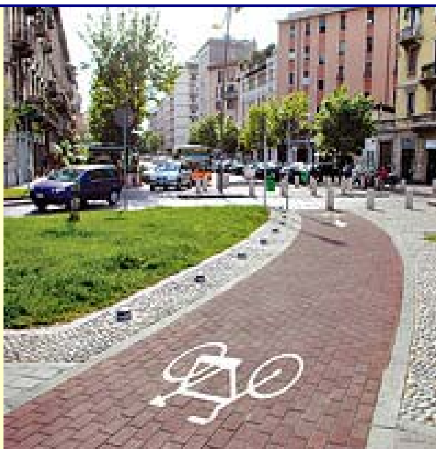
FOTO 12 - Pista ciclabile in blocchetti di cls
