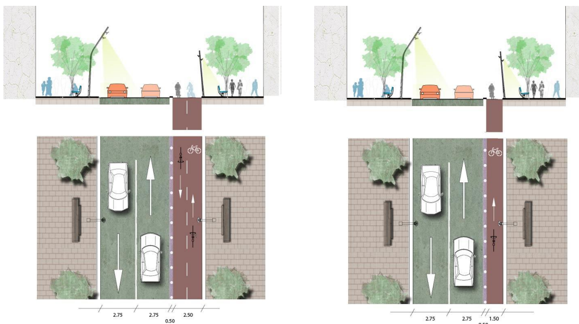
Schema tipo piste ciclabili in sede propria _ Percorso Insediamenti produttivi/ Bike to work e Percorso sportivo
