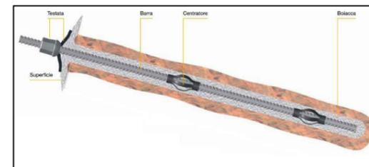
Figura 12: Dettaglio tipo chiodatura
