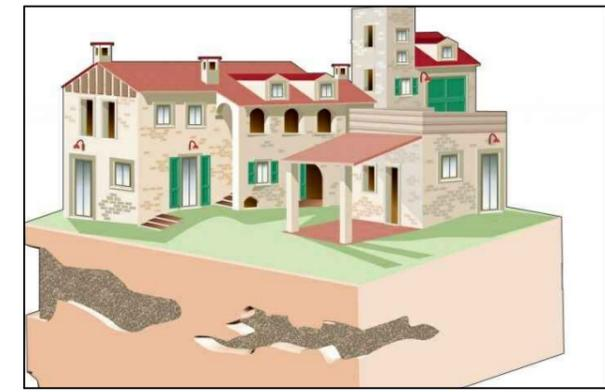
Figura 13: Esempio intasamento cavità sotterranee
