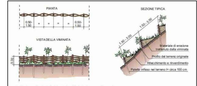
Figura 4: Sezione, vista e pianta tipo viminata
