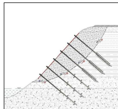
Figura 11: Schema tipo chiodatura
