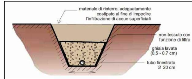
Figura 2: Sezione tipo trincea drenante
