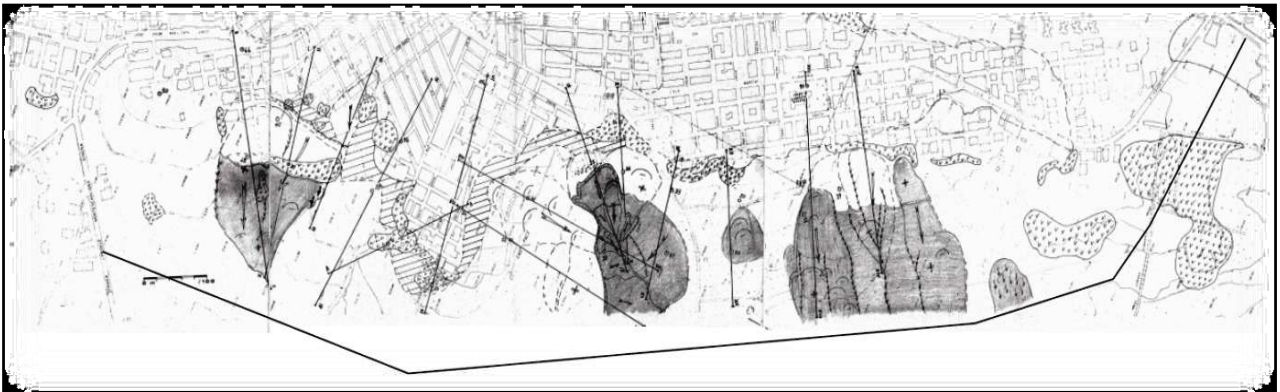
Fig. 27: Gruppi di antiche frane lungo il pendio prospiciente il T. Gravinella (Melidoro, 1985)
