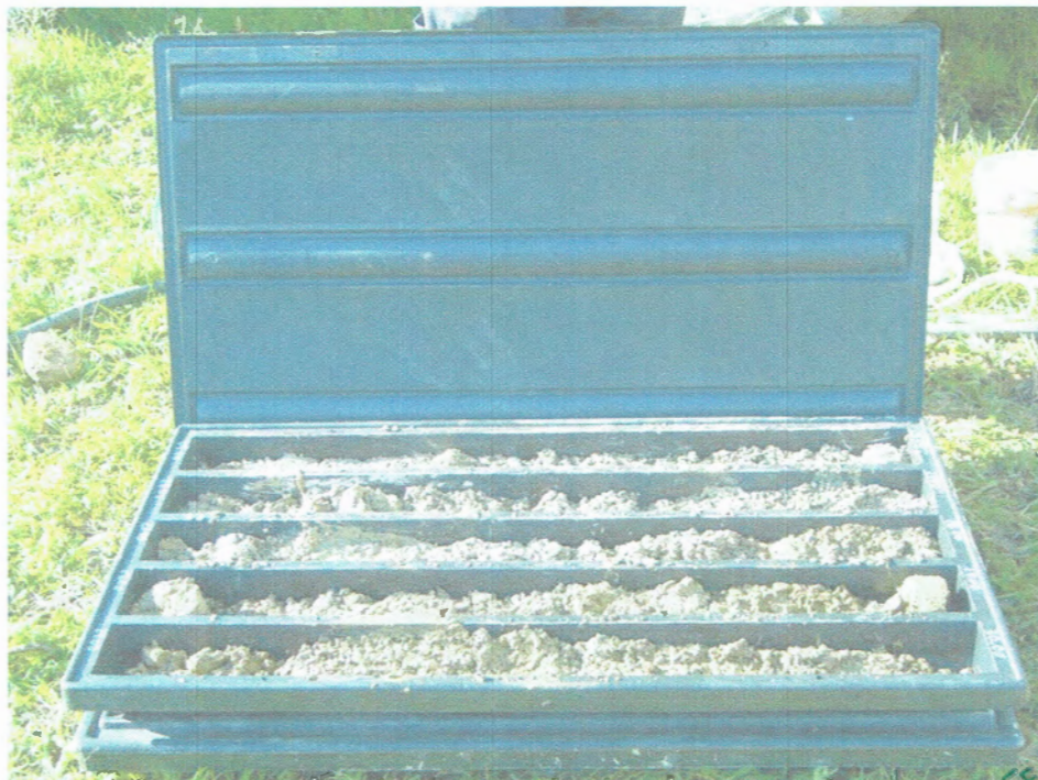
SONDAGGIO GEOGNOSTICO DA M 15,00 A M 20,00
