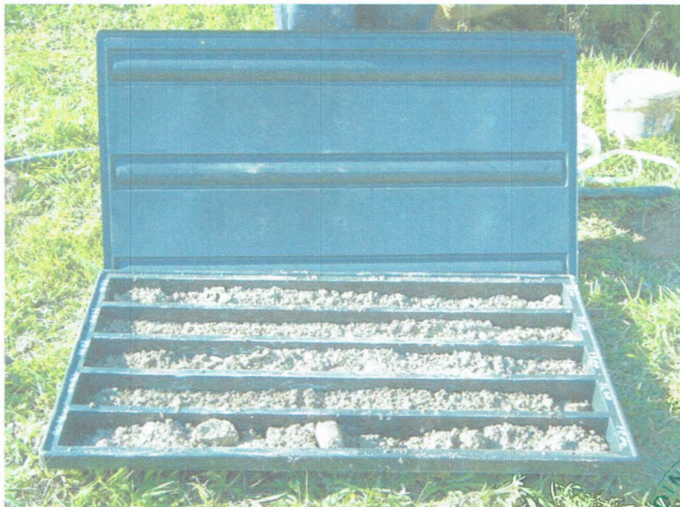
SONDAGGIO GEOGNOSTICO DA M 5,00 A M 10,00
